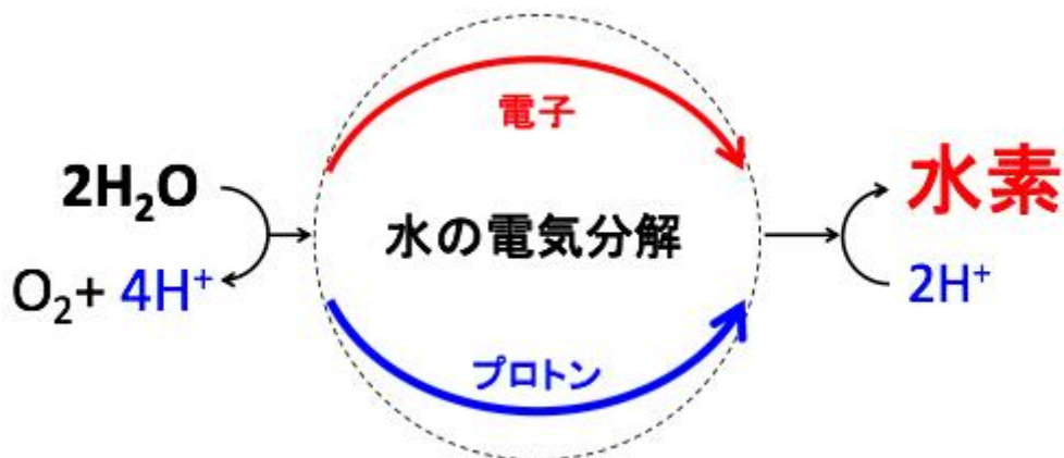
図 水電解反応による水素製造の概念図
