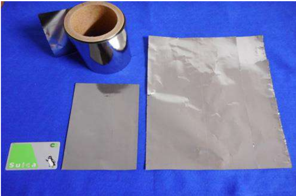
図2 ナノ結晶薄帯（幅127mmと245mm）
