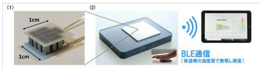
図 1 左)は開発に成功した鉄-アルミニウム-シリコン系熱電発電モジュール (1cm 角サイズ)、中央-右は IoT 機器の試作機 (温度・湿度センサー・BLE 通信機器を内蔵した温度差駆動の自立電源システム) と、データ受信状況
