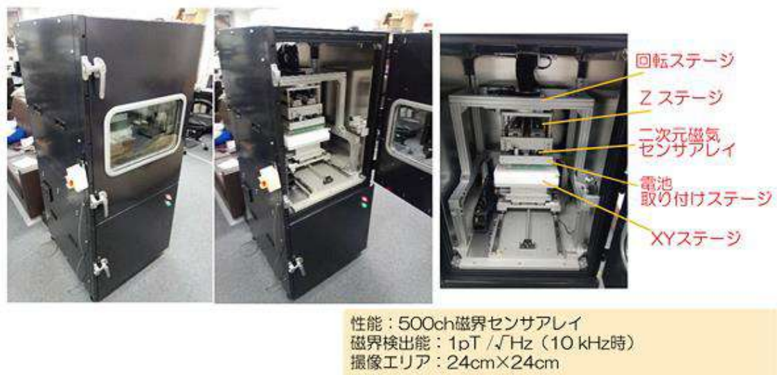
図2 蓄電池の電流密度分布の画像診断システム FOCUS
