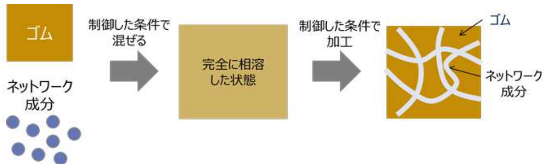
図3 ダブルネットワーク構造を取り入れたゴム複合体の概念図および製造プロセス
