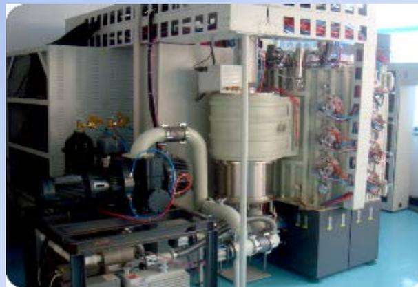
用于制备硬质薄膜的电弧离子度设备
