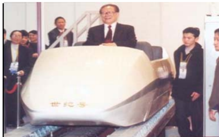
世界第一辆载人高温超导磁悬浮试验车
