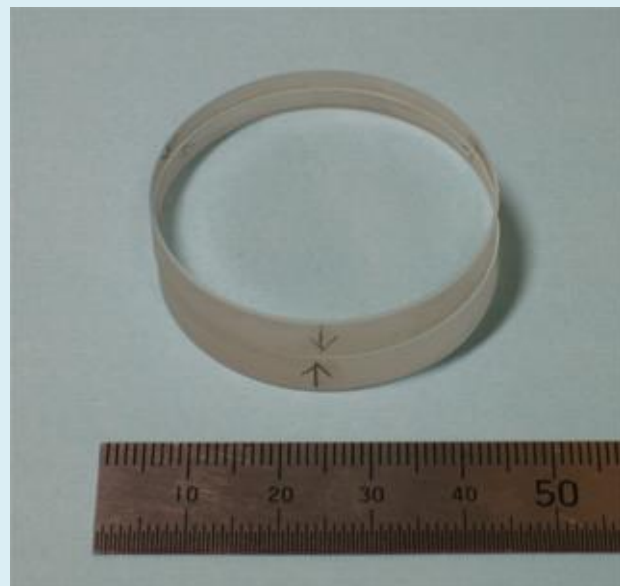
石英玻璃-石英玻璃的接合（直径40mm）
