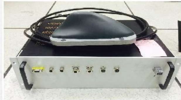
应用于高铁的9卡智慧协同路由器
